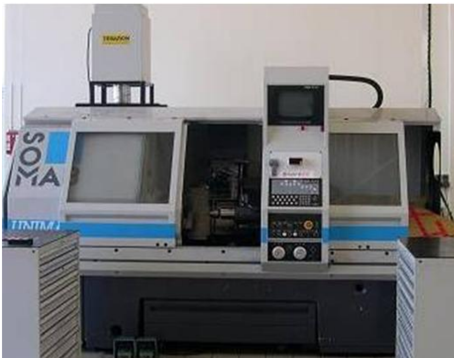
FIGURE 3.4 – Machine utilisée (Tour SOMAB 500)
