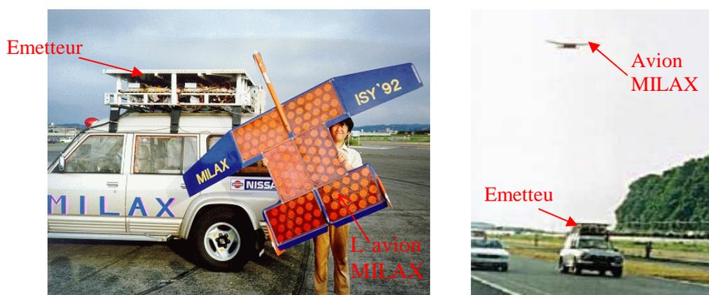
Fig. 1.10. Prototype de MILAX [26], (a) prototype de MILAX utilisant 120 antennes patch circulaire, (b) test de MILAX sur une route au Japon, l'émetteur de puissance RF et le système de contrôle de faisceau sont placés sur le toit de la voiture.
