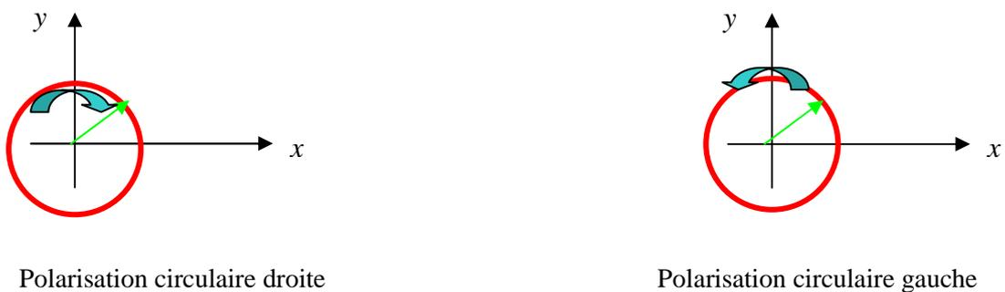
Fig. 2.4. Exemple de polarisation circulaire du champ électrique  $E$ .
