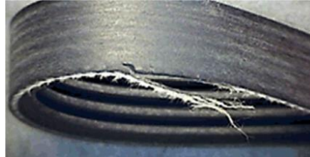
Figure 77 : Défaillance par sortie de câblé
