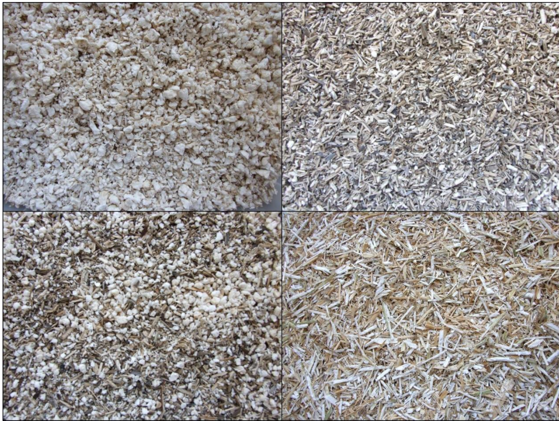
Figure 2-3. Granulats végétaux broyés : En haut à droite: SB, haut à gauche: SP, bas à droite: RS, bas à gauche: SBP
