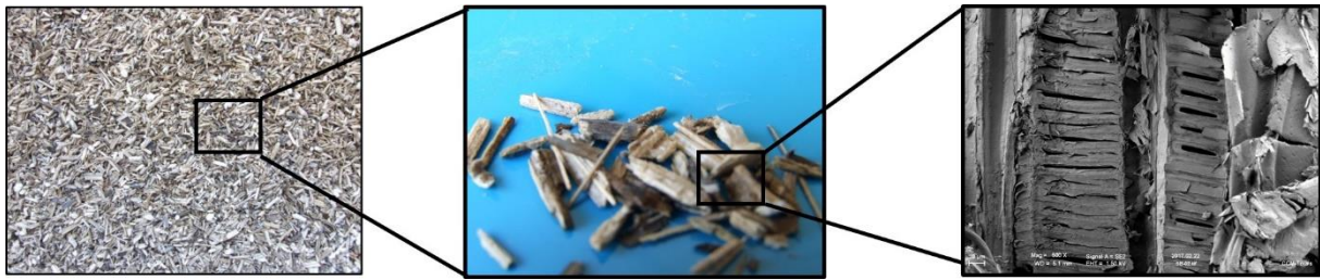
Figure 2-7. Ecorce de tournesol SB, sur la droite, cliché MEB section tangentielle
