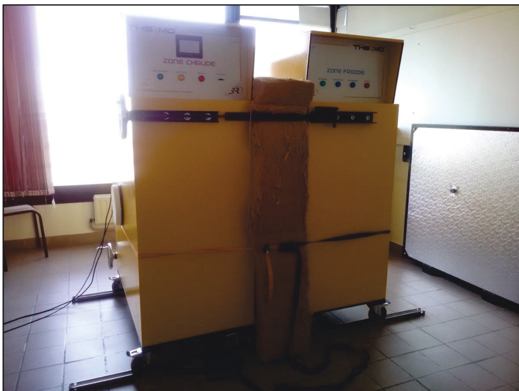
Figure 4-17. Paroi disposée dans la chambre climatique
