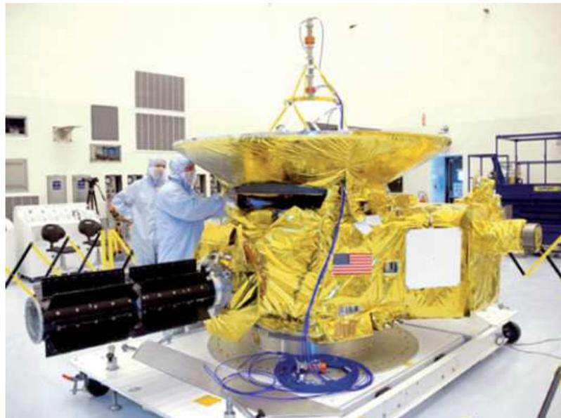
FIGURE I.1.9. – Photographie de la sonde New Horizons équipée d'un module thermoélectrique ( en noir) pour l'étude de Pluton et ses satellites
