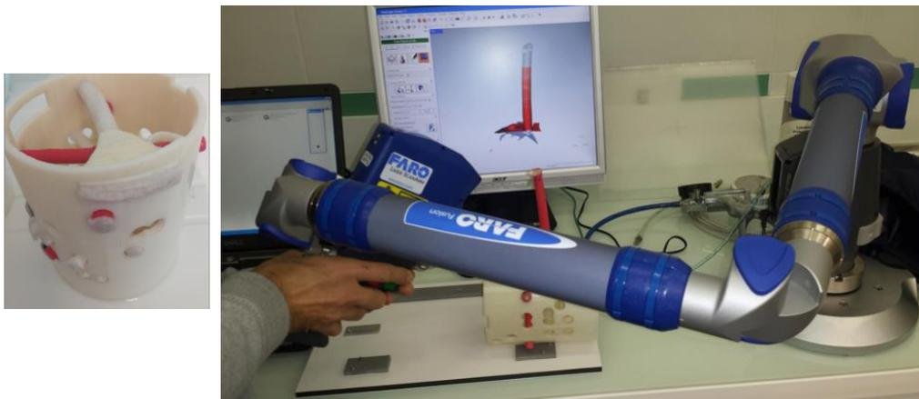
Figure 5.13. Exemple d'acquisition surfacique au scanner laser d'un faisceau de l'objet test.
