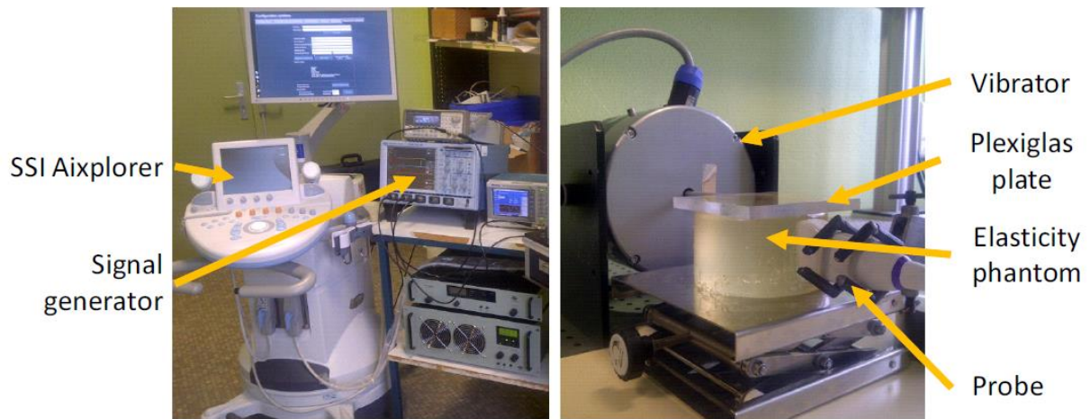
Figure 2-2 Disposition générale de l'expérience. On identifie l'échographe Aixplorer® et le générateur de fonctions (à gauche), ainsi que le pot vibrant, la plaque de plexiglas, la sonde et un fantôme (à droite).
