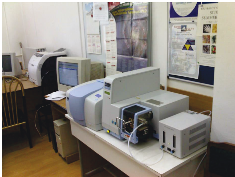
Figure 2.5. Thermo balance Perkin Elmer ("Diamond Differential/ Thermogravimetric Analyser") au sein du Laboratoire de dynamique non linéaire et physique des plasmas, Craiova, Roumanie
