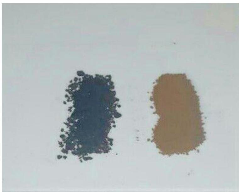
*Figure 2.2 : images de poudres de  $\text{MnO}_2$  obtenues dans le cas d'une synthèse avec le solvant éthanol (noir) et avec le solvant DMF (marron).*
