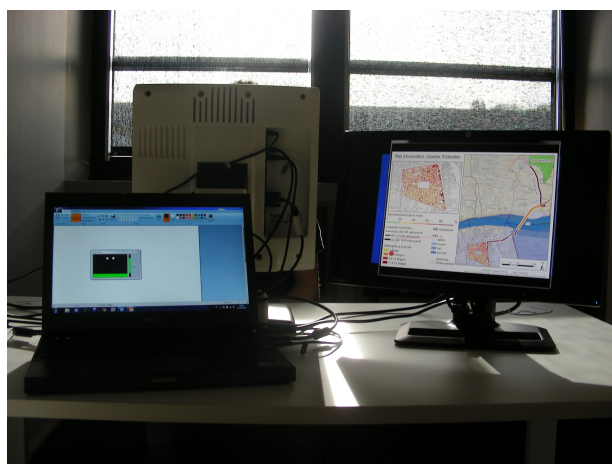
(c) Poste d'enregistrement vu par l'expérimentateur : sur l'écran de droite ce que voit le volontaire avec sa trace oculaire (fixation et saccade) et sur l'écran de gauche la fenêtre de suivi de la qualité de captation du reflet cornéen.
