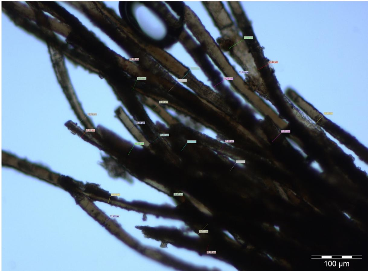
Fig. 110 : mesure partielle de diamètres de fibres de laine à l'aide du logiciel Cell^B®.
