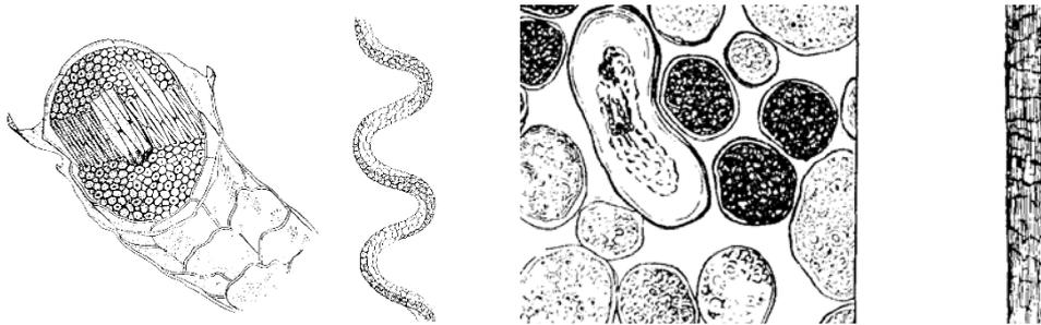
Fig. 15 : coupes transversales et vues longitudinales de laine de mouton (à gauche) et de chèvre mohair (à droite ; GORDON COOK 1993 : 98, 103 ET 134). La différence se voit principalement au niveau de la forme des écailles et de celle de la section de la fibre.
