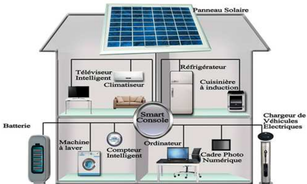
Figure 12 : Exemple d'une communication CPL bas débit entre une console intelligente et les différents appareils domestiques communicants
