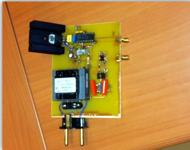
Figure 84. Photo de la carte génératrice ou réceptrice d'impulsion
