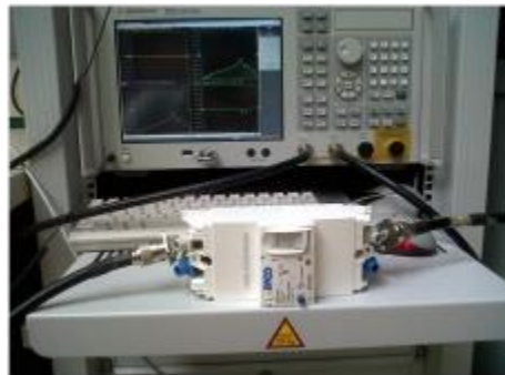
Figure 50. Mesure des pertes d'insertion avec un analyseur de réseau
