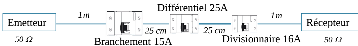
Figure 47. Réseau électrique simple comprenant 3 disjoncteurs
