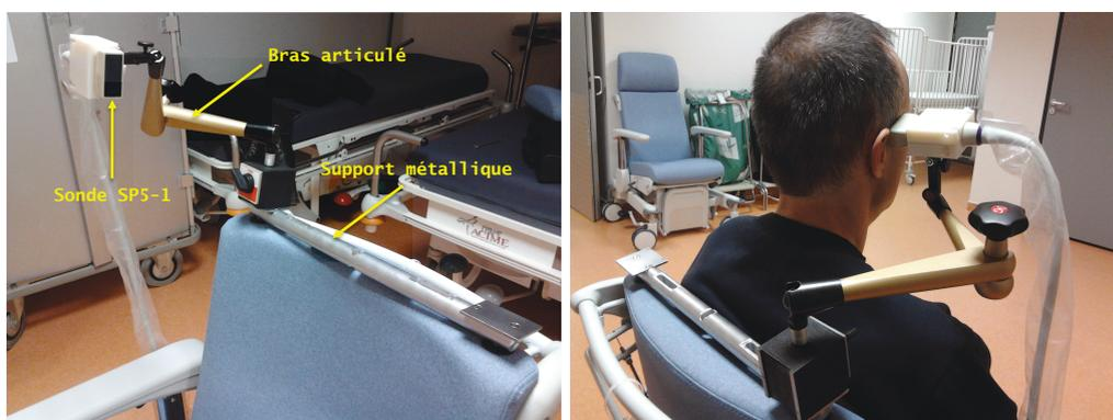
FIGURE 4.2 – Photos de la sonde SP5-1 monté sur le bras articulé.
