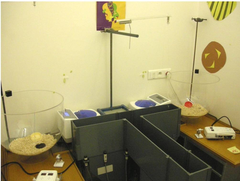
Figure 25 : Dispositif de microdialyse adapté pour la réalisation du test d'AS dans le labyrinthe en T. Le dispositif de microdialyse se compose d'une enceinte (dans laquelle la souris peut se déplacer librement avec de l'eau et de la nourriture *ad libitum*), d'un pousse seringue, d'un collecteur et d'une potence équipée d'un pivot. La potence étant mobile, elle permet le déplacement de la souris dans le labyrinthe en T.
