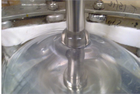
FIGURE 4.15 – Photographie d'un gel de Carbopol obtenu après ajout de soude, illustrant un effet Weissenberg autour de la tige de l'agitateur Ystral.
