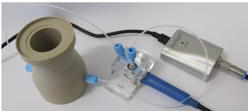
Figure II.12. Photographie de la cuve de nébulisation adaptée pour l'électrochimie, de la cellule en flux comportant la SPE et du potentiostat compact (de gauche à droite)
