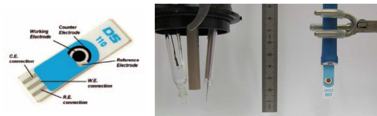
Figure II.13. Photo d'une SPE (gauche) et comparatif d'encombrement entre un système classique à 3 électrodes et une SPE (droite)
