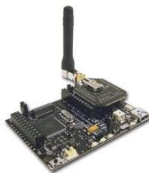
FIGURE 4.5 – Routeur Wasmote avec un transceiver Bluetooth.
