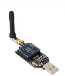
FIGURE 4.4 – Coordinateur Waspote avec son module XBEE.
