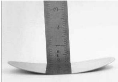
Figure I-16 : Exemple de plaquette 2" illustrant la contrainte d'une couche de 3C-SiC/Si de 2 $\mu$ m épitaxié sur du Si(111) [41]
