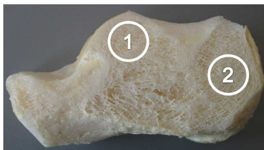
FIGURE 3.1 – ROI soumises à des mesures DAET. La zone (1), de plus faible porosité que la zone (2), se situe sous l'articulation talocalcanéenne postérieure et est soumise à de forts niveaux de sollicitation mécanique.
