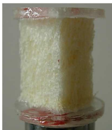
FIGURE 3.12 – Epreuve d'os trabéculaire dont les extrémités sont encapsulées.
