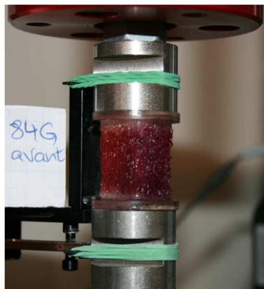
FIGURE 4.5 – Echantillon inséré dans la machine de test pour subir l'essai de compression en fatigue (la couleur rose est due à la première coloration à l'alizarine complexone du protocole d'histologie).
