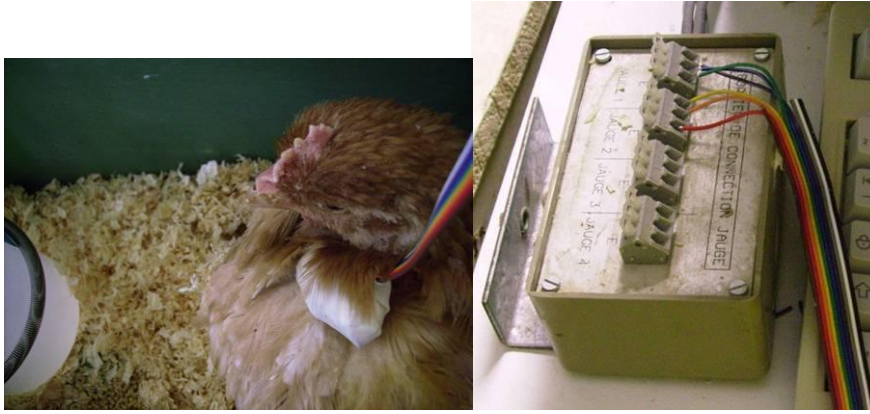
Figure 31. À gauche, un poulet avec son doigt de gant (jauges repliées à l'intérieur); à droite, le boîtier de connexion des jauges de contrainte.
