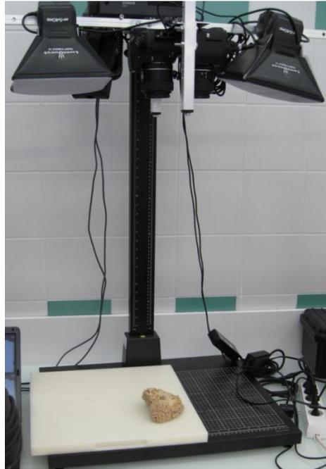
Figure IX-8 Utilisation du système d'acquisition stéréoscopique Pentax pour la modélisation anatomique d'un cerveau
