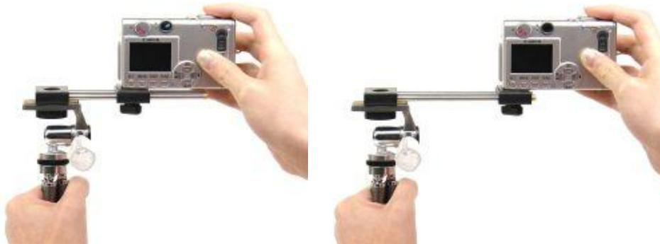
Figure III-8 Principe du décalage entre les deux prises de vue. A droite une première prise de vue  $T_1$  (vue de droite) et à gauche une deuxième prise de vue  $T_2$  (vue de gauche) (Digital 3-D Cameras s.d.)
