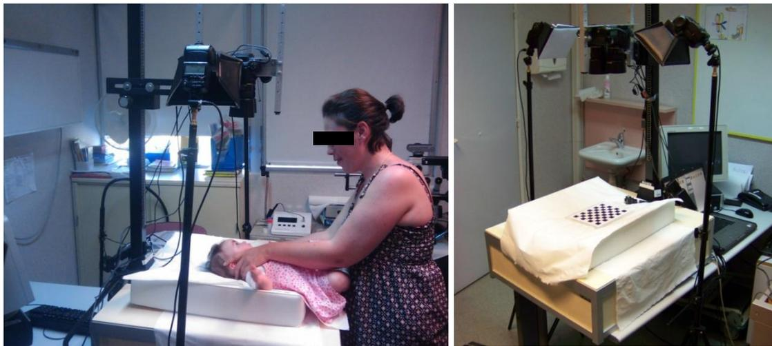
Figure IX-6 Système d'acquisition avec appareils PENTAX K10D adapté à la prise de vue de bébés atteints d'hémangiome (Hopital Saint André de Bordeaux)
