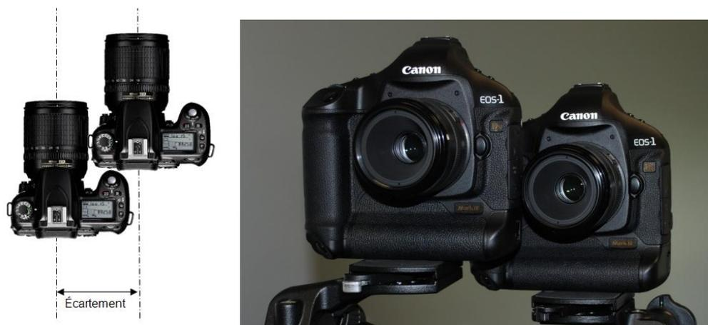
Figure IV-2 Position en cascade de deux appareils photographiques
