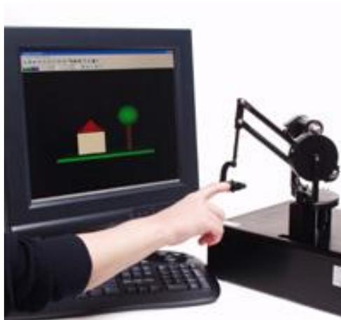
Figure II-2 Scanners avec contact, Sensable Phantom Premium 1.0 (Sensable Phantom Premium 1.0 s.d.)
