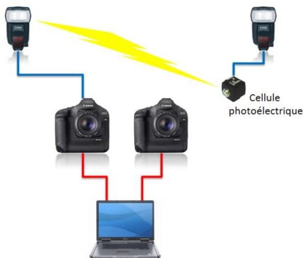
Figure IV-12 Utilisation de cellule photoélectrique
