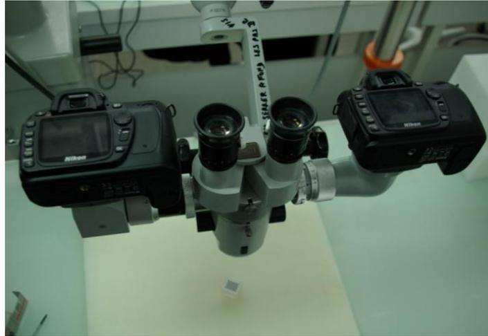
Figure III-16 Microscope stéréoscopique équipé de deux appareils photo Nikon D80 (dispositif testé dans la thèse en collaboration avec l'U930 de l'Inserm)
