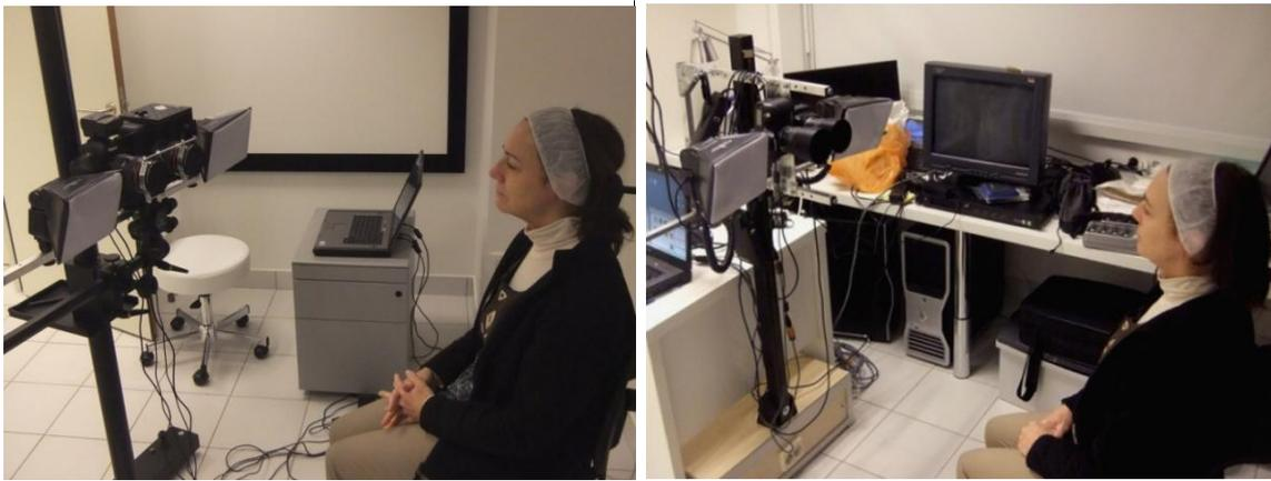
Figure IX-2 Système de prise de vue stéréoscopique Canon à gauche et Pentax à droite
