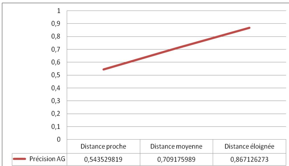
Figure VIII-12 Précision de l'algorithme génétique de calibrage en fonction de l'éloignement des mires utilisées pour l'apprentissage et le test
