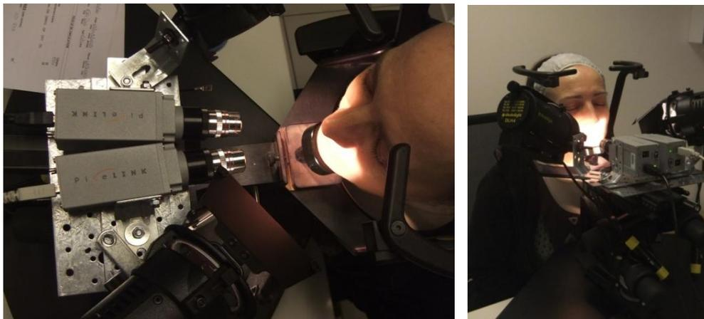
Figure IX-3 Système de prise de vue macro Pixelink
