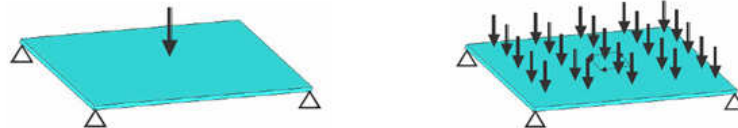
FIG. 4.5 – a) Modèle statique avec déflexion au centre du circuit imprimé – b) Modèle statique avec flexion répartie sur l'ensemble du circuit imprimé
