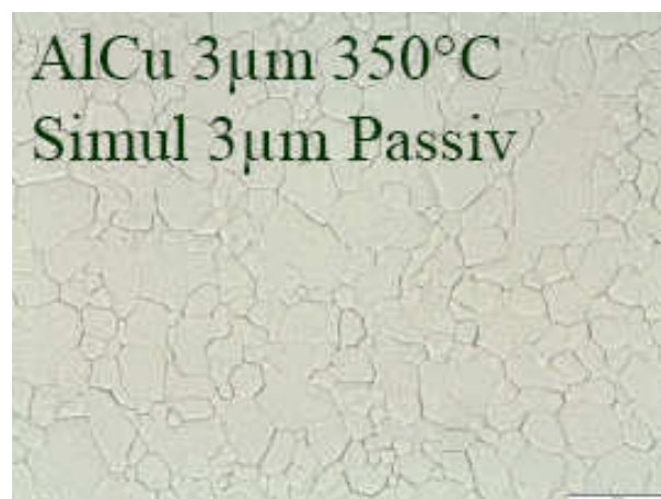
FIG. D.2 – AlCu d'épaisseur 3 \mu\text{m} déposé à 350 °C
