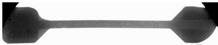
FIG. B.2 – Eprouvette moulée vue aux Rayons X
