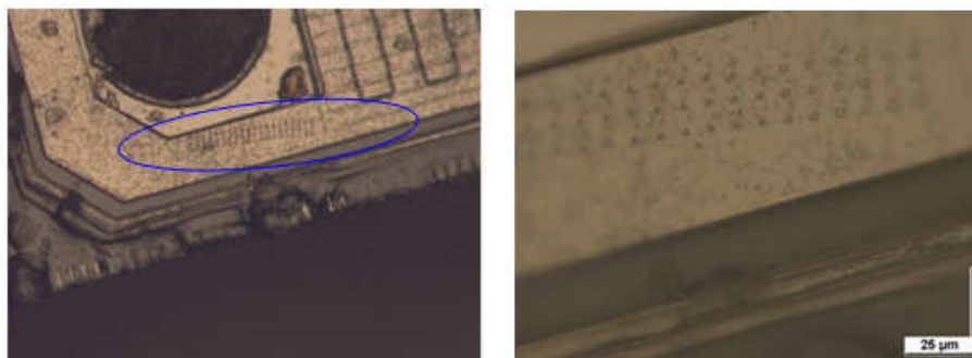
FIG. 3.23 – Observation des indentations sur Al-Cu - a) Vue générale - b) Agrandissement
