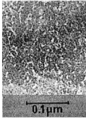
Figure I.8 : Image TEM de silicium poreux réalisé dans un silicium de type P de résistivité 1 \Omega.cm [33]
