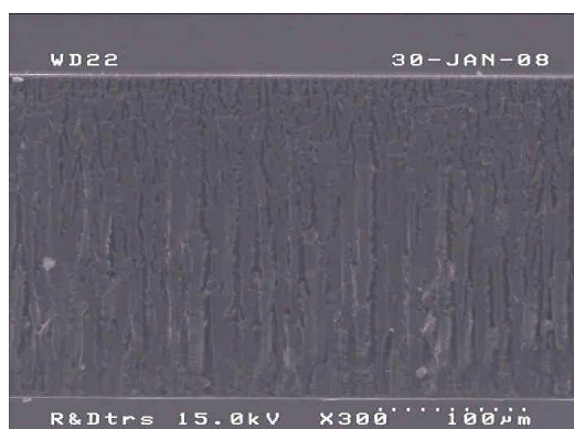
Figure II.20 : Image MEB en vue de coupe pour une densité de courant de 12,23 \text{ mA/cm}^2
