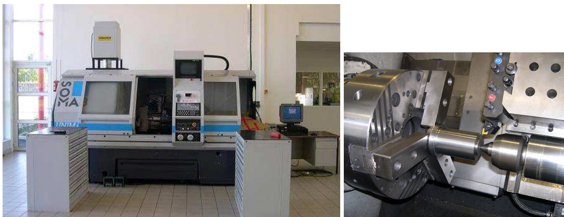
Figure 34: Tour CNC SOMAB 500 utilisé pour les essais de chariotage. A droite la photo de la pièce, de l'outil monté sur la table dynamométrique.
