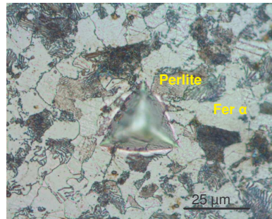
Figure 33: Structure métallographique de l'acier 27MnCr5 à l'état recuit après indentation. Mis en évidence des phases perlite lamellaire et fer \alpha après attaque au nital (3%).
