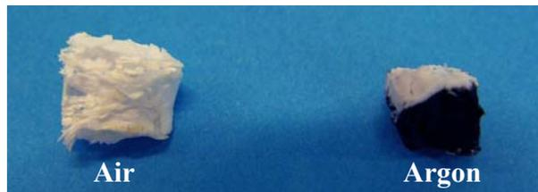
Figure III-9. Résidus obtenus après analyses thermogravimétriques de HDK H30RM jusque 1400°C sous air et sous argon
