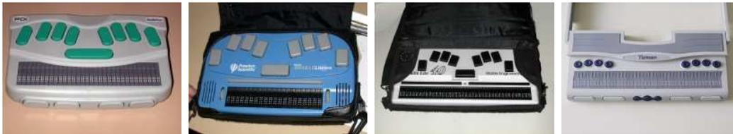
FIGURE 2.15 – Exemple de terminaux braille (Braillette, Braillete, Voyager)(images extraites du site Libbraille : <http://libbraille.org/>)
