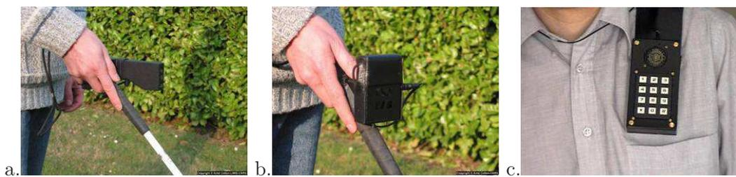
FIGURE 3.4 – Exemples d'aides à la navigation pour les personnes aveugles : la canne blanche électronique (a. Teletact, b. TomPouce, c. GeoTact)(images extraites du site du laboratoire Aimé Coton, Paris).
