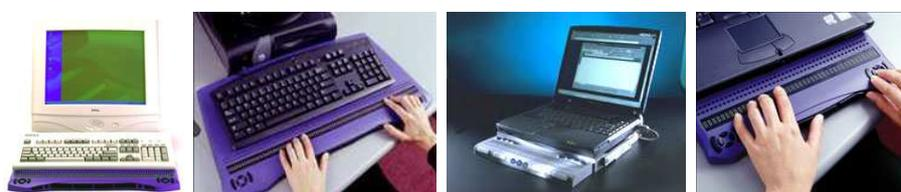
FIGURE 2.14 – Exemple d’utilisation conjointe d’un afficheur braille avec un PC ou un portable (images extraites du site Libbraille : <http://libbraille.org/>)
