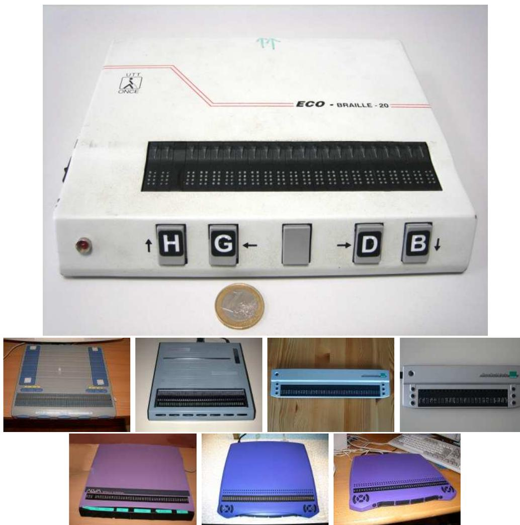
FIGURE 2.13 – Exemple d’afficheurs braille de différentes marques (ONCE, Eurobraille, Pappenmeier, Alva, Vario). L’afficheur ONCE ECO 20 (afficheur principal de cette illustration) est celui utilisé durant ces travaux de thèse (images personnelles ou extraites du site Libbraille : <http://libbraille.org/>)
