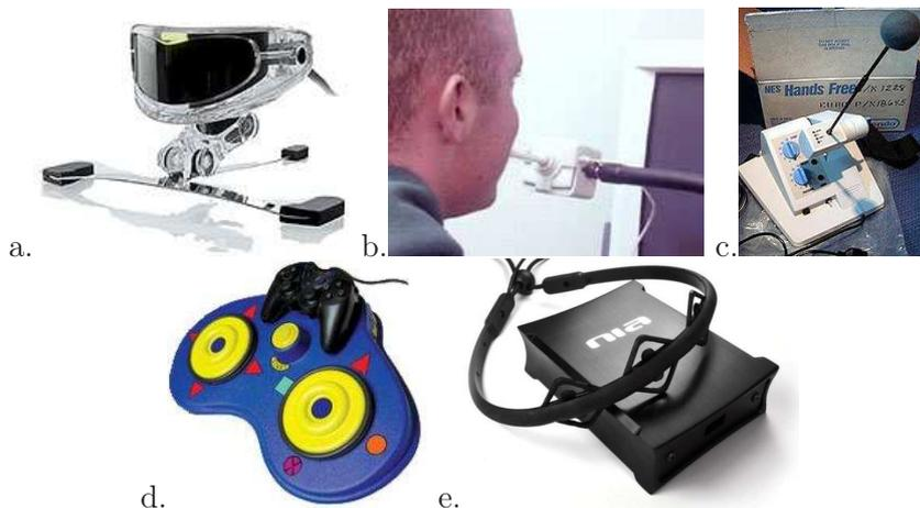
FIGURE 3.9 – Exemple de contrôleurs accessibles (a.« head »tracker, b.contrôleur lié au souffle, c.contrôleur Nintendo « Hand Free », d.« PlayStation Control Center »(images extraites du site <http://www.oneswitch.org.uk/>) e. OCZ Neural Impulse Actuator (image extraite du site <http://www.matbe.com/actualites/40171/ocz-nia/>)
