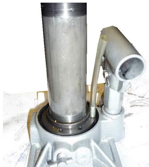
Figure 19: Photo d'illustration de la mise en place du tuyau d'aspiration [5]
