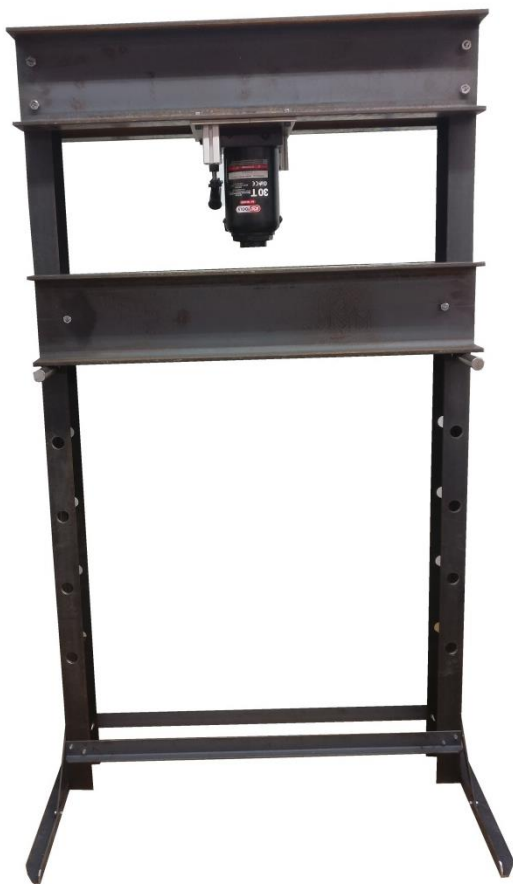
Figure 15: Montage "à blanc" de la presse
