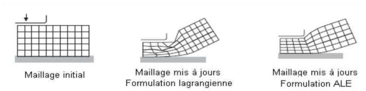
Figure 3. Difficultés associées aux Formulation Lagrangienne et réparation ALE (ref. PFE_de Schoubrenner Mathieu, INSA Strasbourg, 2009)
