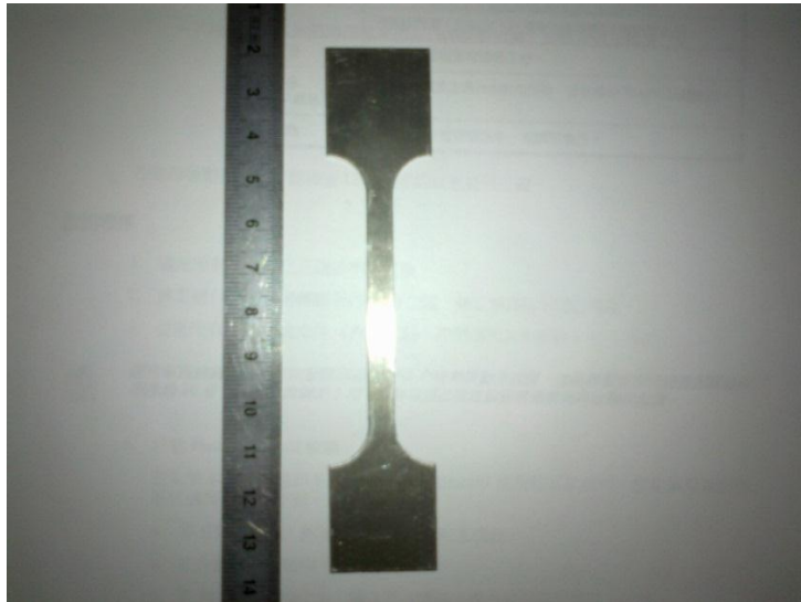
Figure 5. Eprouvette de dural (AU4G) – épaisseur =1mm, largeur = 6mm, Longueur =50mm
