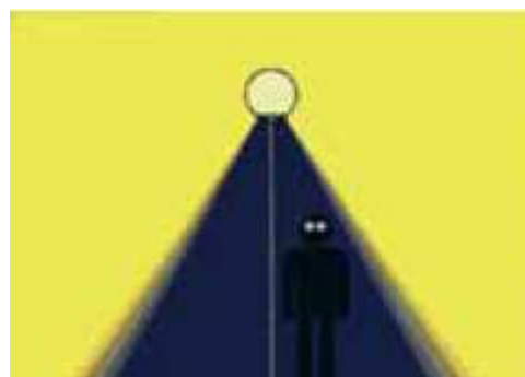
Figure 4 : Illustration de direction de la lumière pour les candélabres "boules"
